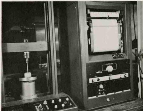
FIGURE 2. TESTING MACHINE SET UP FOR COMPRESSION PLUNGER TEST
